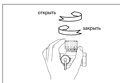
Перекрытие потока выполняется вращением рукоятки до упора по часовой стрелке. Открытие клапана – в обратную сторону до упора. При этом настройка сохраняется. При закрытом положении клапана слив будет возможен из трубопровода со стороны расположения дренажного крана.
