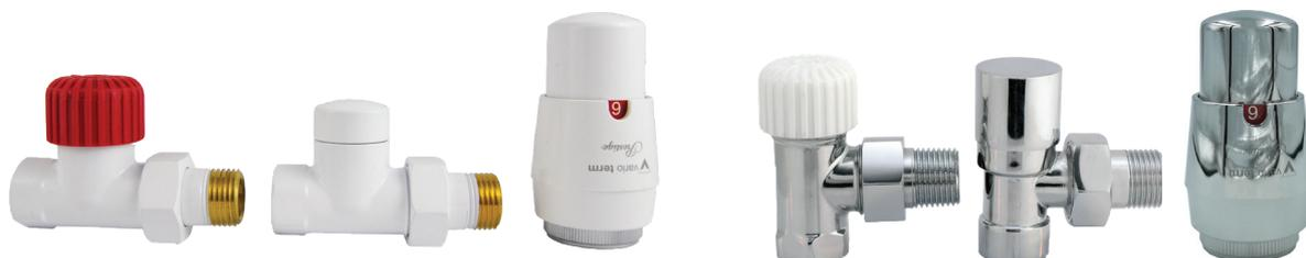
Установочный комплект „Royal“ угловой или прямой, резьба внутр. 1/2" / резьба внеш. 1/2", резьба М30х1,5. Предназначен для монтажа на радиаторе (в ванной или декоративные) центрального отопления в двухтрубной системе со стороны поступления воды. В комплекте с термостатической головкой регулируют количество теплоносителя, поступающего в радиатор. Термостатическая головка „Prestige“ GS.02.
